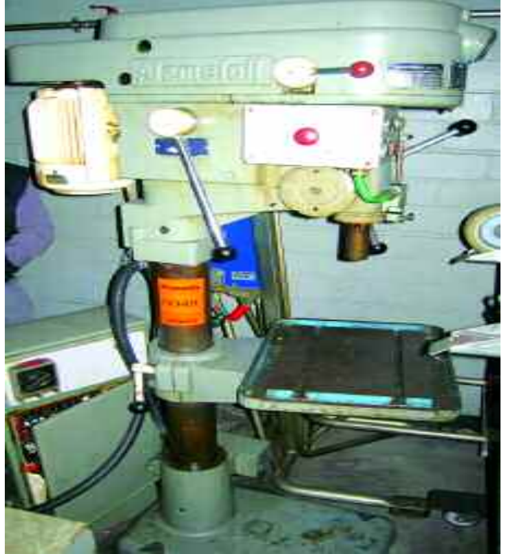
ALZMETALL AB 3 ES Säulenbohrmaschine, Bohrleistung 30 mm pillar drilling machine, outreach 300 mm
