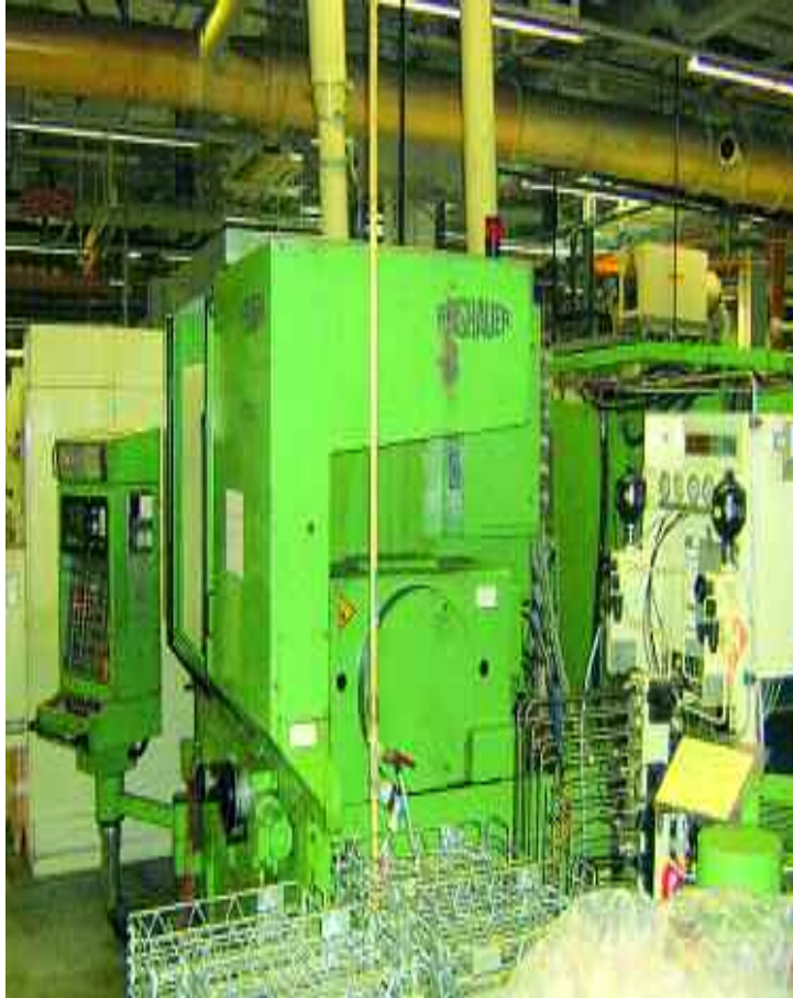
REISHAUER RZ 362 A 1999 CNC-Wälzschleifmasch. Ø 360 x Mod. 7 CNC gear grinder, gear width 175 mm
