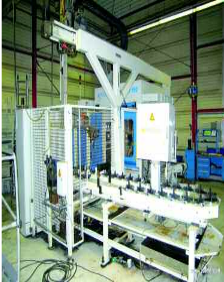
PFAUTER SH150 CNC Wälzfräs-Wälzstoßmaschine Shobber Ø 150 x Mod. 4
