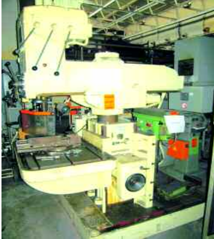
SCHLUMBERGER RF 4 Schnellradialbohrmaschine, Bohrtiefe 350 mm rapid radial drilling machine, table dimension 1000 x 700
