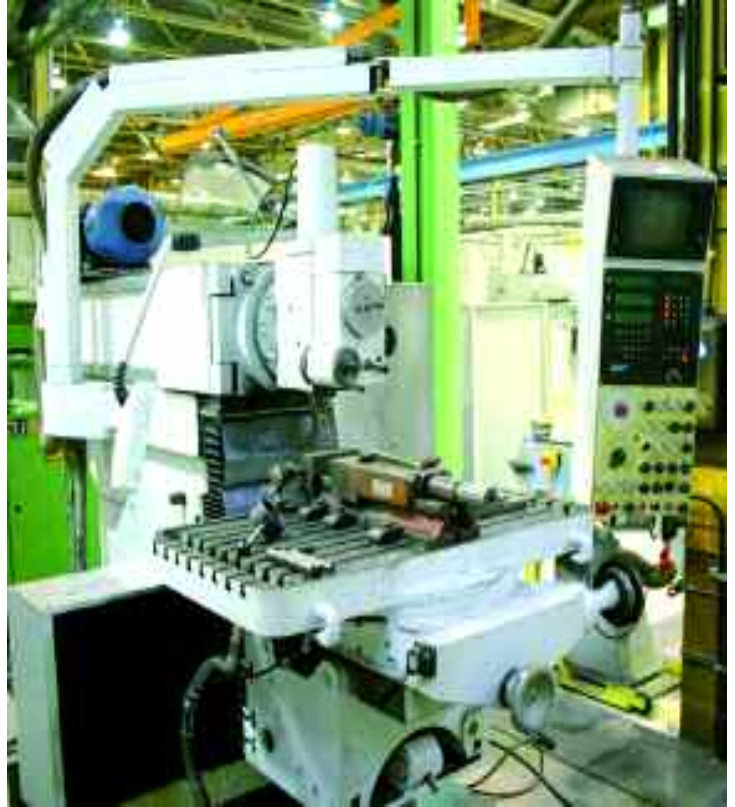
MAHO MH 800 P Universalfräsmaschine 800 x 450 x 500 universal milling machine + Heidenhain
