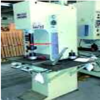
WINTER MTP 12 1997 Hydr. Einständerpresse 12 t x 500 mm Höhe hydraulic press, stroke 350 mm
